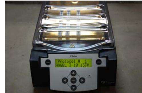
Fig. 23. Separación de proteínas por Isoelectroenfoque
