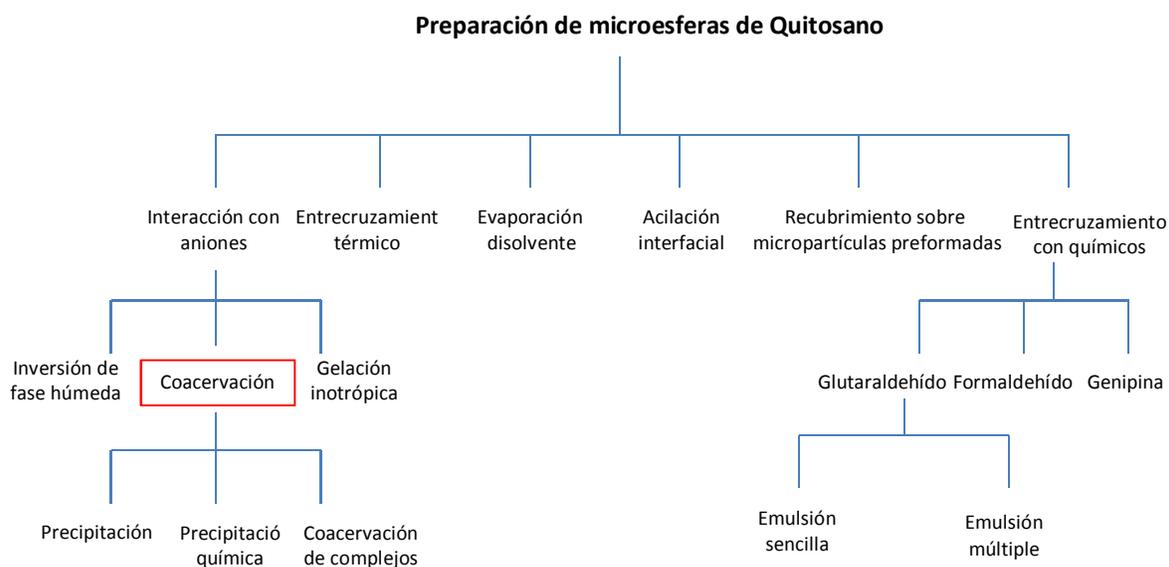
Figura 11. Principales métodos para la preparación de esferas de quitosano. (Adaptado de Sinha, 2004), [184].
