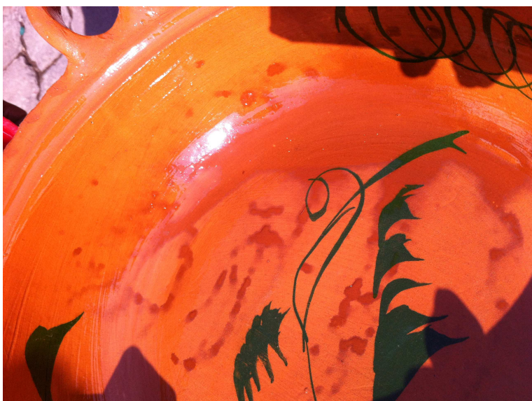
Imagen 6. Pieza de barro que al mojarse se vuelve porosa absorbiendo el agua, delatando así su vidriado con óxido de plomo.
