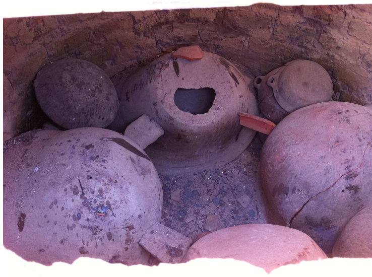
Imagen 5. Piezas de barro vidriado tras la primera cocción o “jahuate”.
